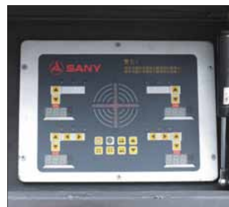
Monitoramento Eletrônico de Pressão das Patolas
